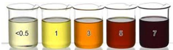
Рисунок 7 – Цифровое изображение моторных масел с баллами по шкале ASTM D 1500
