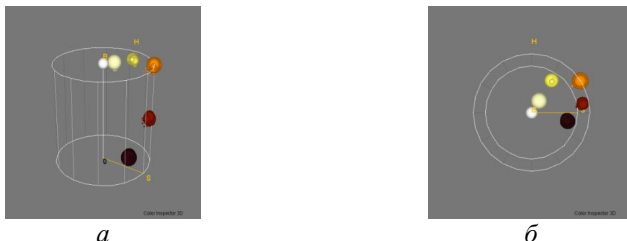
Рисунок 8 – Изображение модели HSB моторных масел: а – аксонометрия; б – вид сверху
