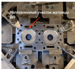
Рисунок 5 – Деталь матрицы пресс-формы, восстановленная лазерной наплавкой
