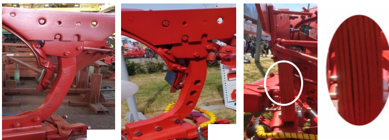
Рисунок 3 – Грядиль плуга с традиционной конструкцией (а) и с модифицированной многослойной конструкцией (б), изготовленной с использованием SL-технологии
