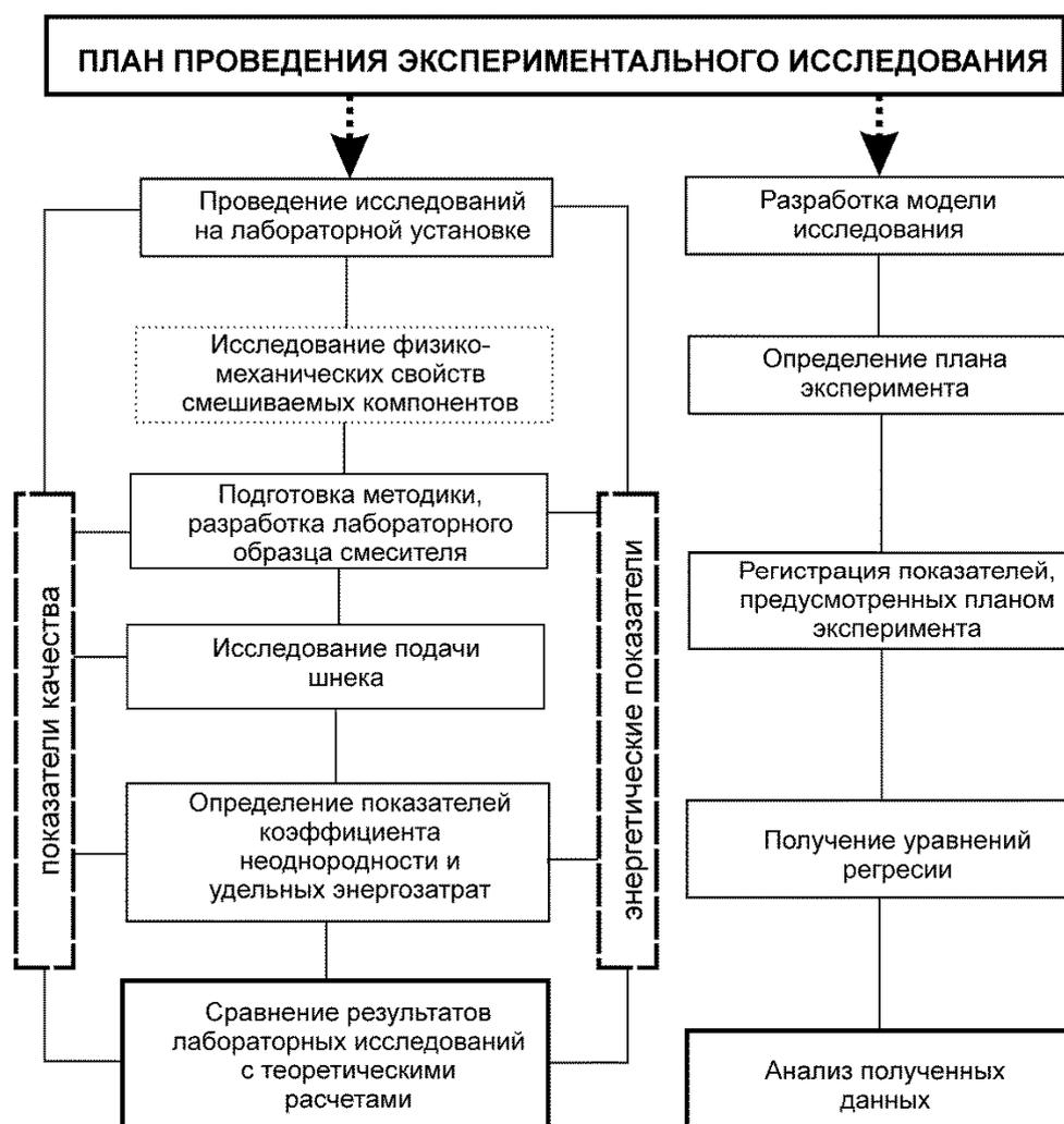
Рисунок 1 – Последовательность выполнения экспериментов
