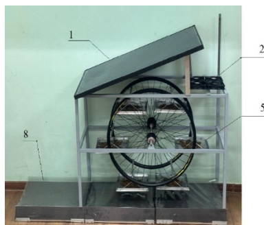
1 – солнечная электропанель; 2 – вытяжной вентилятор; 3 – электронный блок управления; 4 – кожух для направления потока теплого воздуха; 5 – стеллажи с пергой; 6 – вращающиеся колеса; 7 – датчик температуры воздуха; 8 – прозрачная пленка; 9 – коллектор Рисунок 2 – Схема и общий вид гелиосушильной установки для гранул перги
