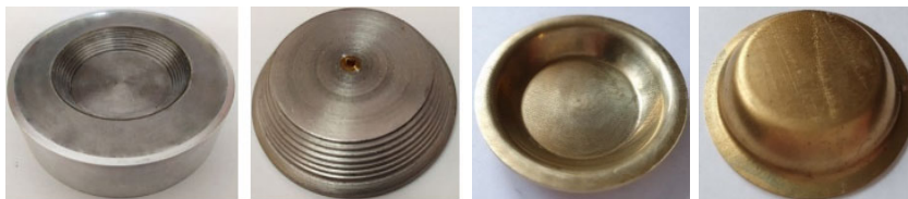
Рисунок 2 – Матрица и пуансон пресс-формы для листовой штамповки металлов (слева) и отштампованная металлическая деталь в форме тарелки
