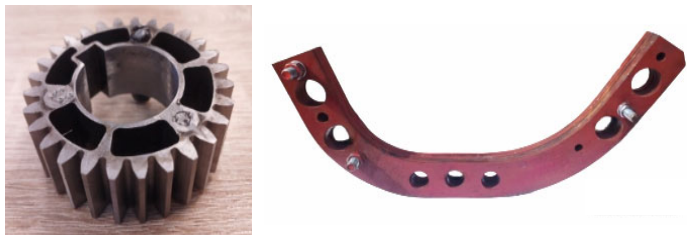
Рисунок 1 – CSB-SL-конструкции шестерни и грядиля плуга
