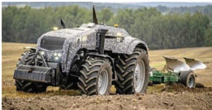
Рис. 2. Автономный беспилотный трактор «БЕЛАРУС-А3523i» с электромеханической трансмиссией
