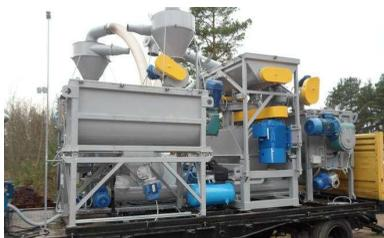
Рисунок 2 – Мобильный комбикормовый завод производительностью 4 т/ч
