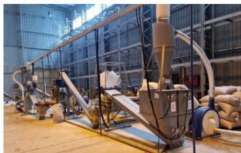
Рисунок 3 – Комплект оборудования КЛК-0,7 для производства легкоусвояемого концентрата
