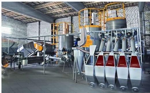
Рисунок 1 – Комплект оборудования для производства белково-витаминных добавок (БВМД) на основе рапсового жмыха КДР-0,8
