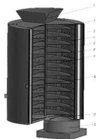
Рисунок 4 – Установка с магнетронным резонатором для термообработки вторичного мясного сырья комплексным воздействием электрофизических факторов
