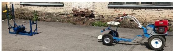
Рисунок 4 – Стенд для определения усилия на перекатывание и буксование
