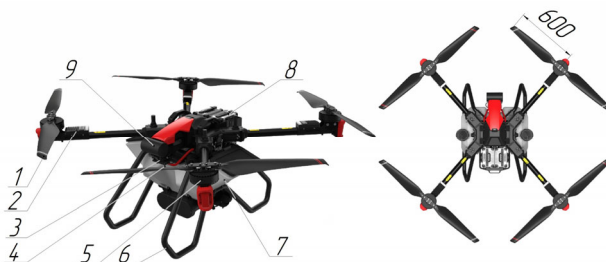
Рисунок 1 – Сельскохозяйственный дрон XAG P100: 1 – винт, 2 – электронный регулятор скорости, 3 – пилотный прицел, 4 – модуль рельефа местности, 5 – электродвигатель, 6 – шасси, 7 – резервуар для жидкости, 8 – батарея, 9 – радар
