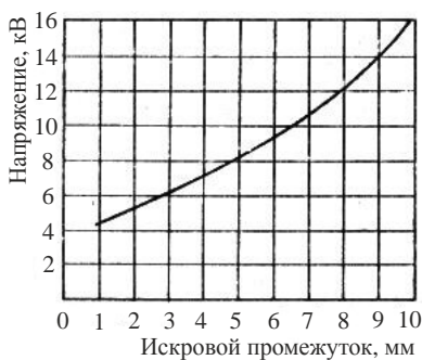
Рис. 2.11.13. Величина искрового промежутка трехэлектродного разрядника
