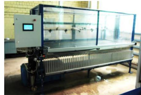
Рисунок 3. Лабораторные установки открытого (а, б) [3, 21, 22] и закрытого (б, в) типов [18; 22] для количественной оценки сноса жидкости: а, в – схемы; б, г – общий вид; 1 – заслонка; 2 – регулятор; 3 – вентилятор; 4 – распылитель; 5, 6 – улавливающие коллекторы (принимающие поверхности); 7 – мерные цилиндры;  $u$  – скорость ветра
