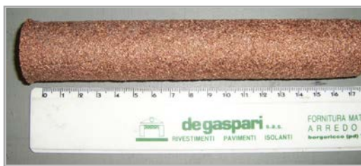
Рис. 4. ФЭ, изготовленные из медных кабельных отходов методом СИП: a – цилиндрической формы; б – цилиндрической формы с доньшком; в – цилиндрической формы с доньшком и ребристой поверхностью
