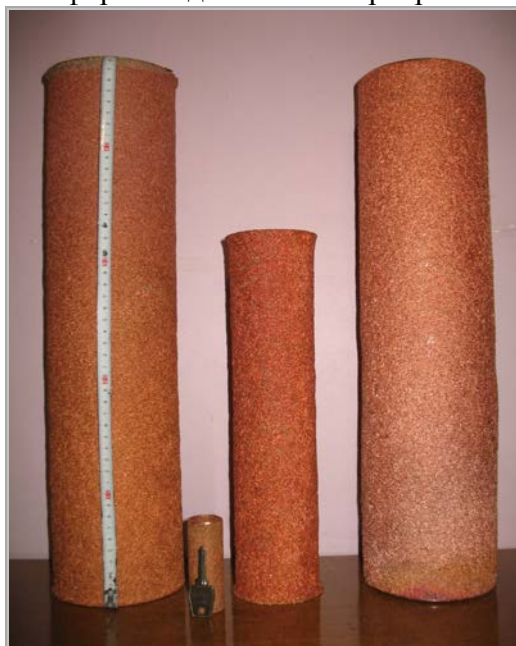
Рис. 5. Крупногабаритные ФЭ из медных кабельных отходов
