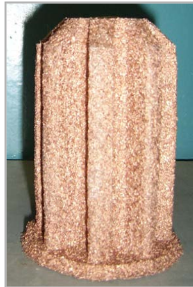
Рис. 4. ФЭ, изготовленные из медных кабельных отходов методом СИП: a – цилиндрической формы; б – цилиндрической формы с доньшком; в – цилиндрической формы с доньшком и ребристой поверхностью
