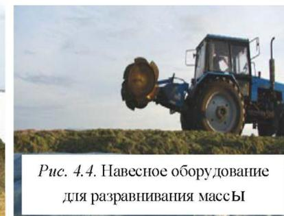
Рис. 4.4. Навесное оборудование для разравнивания массы Б
