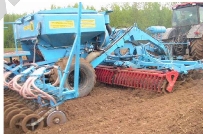
Рис. 6.19. Агрегат комбинированный почвообрабатывающе-посевной АППА-6-01
