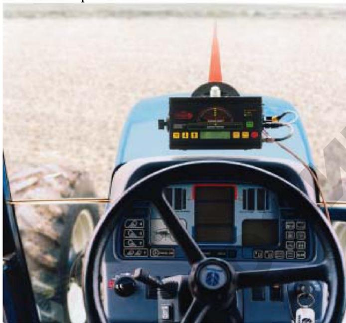
Рис. 7.2. Система параллельного вождения на базе GPS-навигации
