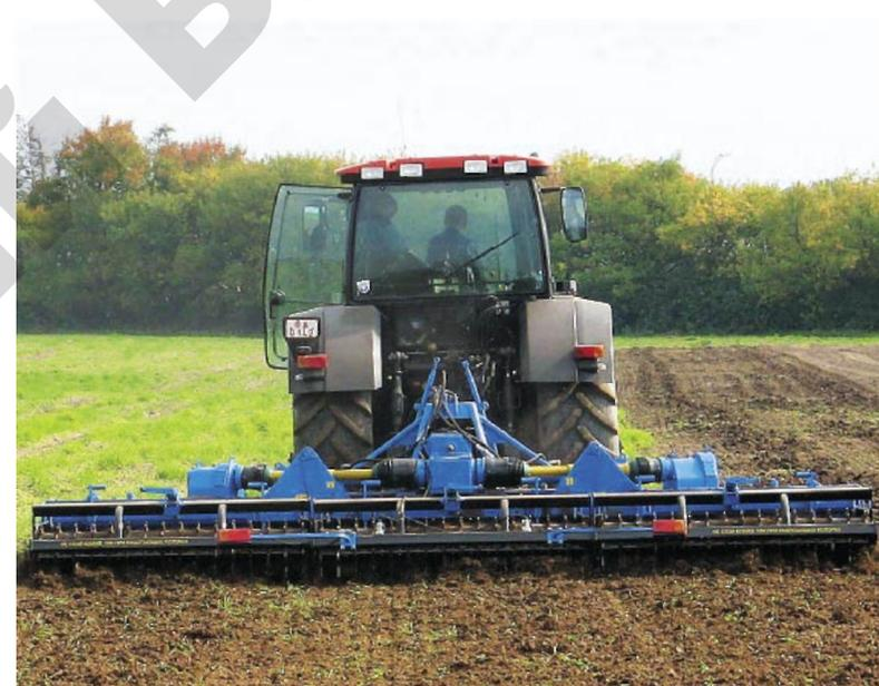
Рис. 6.18. Агрегат комбинированный почвообрабатывающий АКП-6
