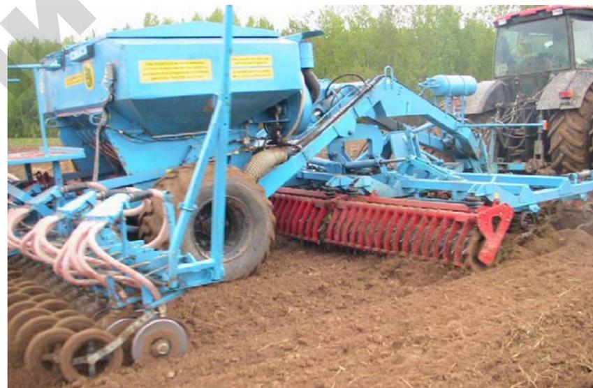
Рис. 2.3. Агрегат комбинированный почвообрабатывающе-посевной
