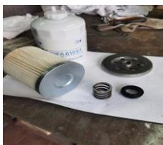
**Рисунок 1. Разобранный фильтр тонкой очистки топлива DIFA 6101/1**
