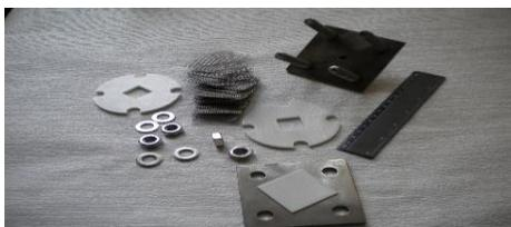
**Рисунок 2. Разобранный экспериментальный образец фильтроэлемента из ФМТС**
