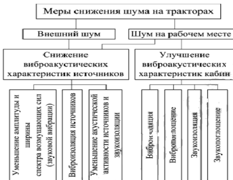
Рисунок 2 — Структурная схема мер снижения шума на рабочем месте оператора [9]
