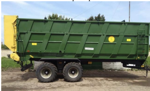
Рисунок 1 – Разбрасыватель твёрдых органических удобрений РТУ-15 с задним поворотным бортом
