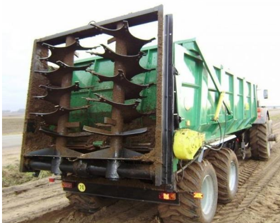
Рисунок 2 – Прицеп РТУ-15 с разбрасывателем твёрдых органических удобрений
