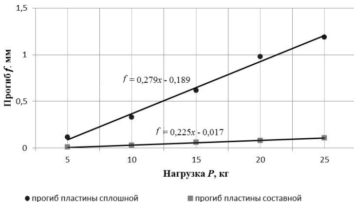
Рис. 5.5. Экспериментальная зависимость прогиба пластины толщиной 4 мм от величины давления P
