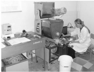
Рис. 4.6. Проведение экспериментальных исследований на малом макаронном прессе МИТ-2
