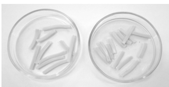
Рис. 4.7. Образцы полученных при испытаниях макаронных изделий с использованием специальных вставок (слева) и без вставок (справа)
