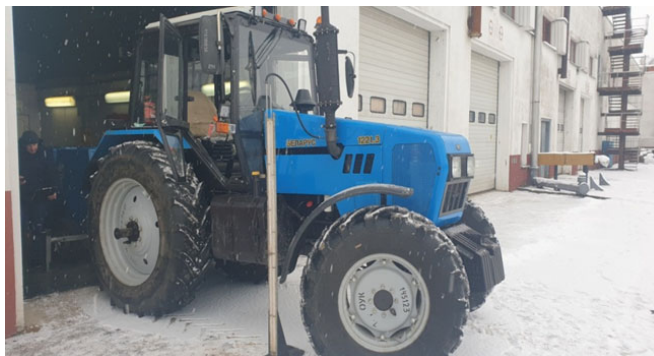
Рисунок 3. Испытания глушителей на тракторе «БЕЛАРУС 1221.3»
