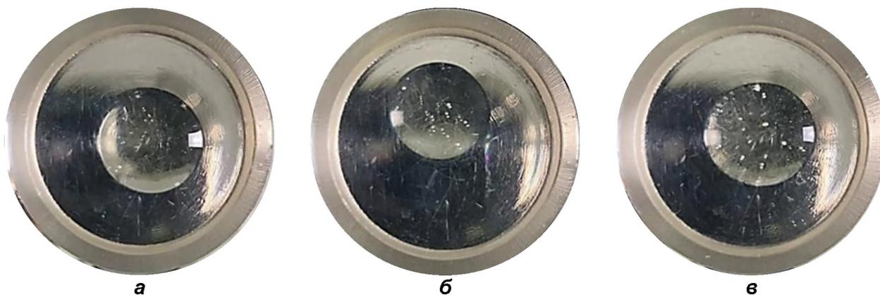
Рисунок 5. Результаты апробации свежего ММ марки Лукойл Авангард 10W40 с различным количеством искусственно введенной воды: а – 0,1 %; б – 0,2 %; в – 0,4 %
