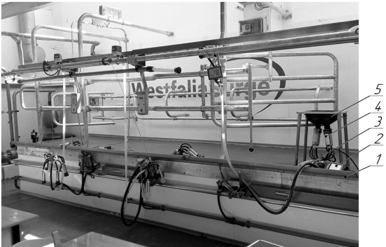
Рисунок 2. Общий вид экспериментальной установки Westfalia: 1 – доильная установка «Westfalia»; 2 – тестер VPR-100 Delaval; 3 – газовый счетчик РБГ У G2,5А; 4 – доильный аппарат с изменяемым вакуумметрическим давлением; 5 – искусственное вымя
