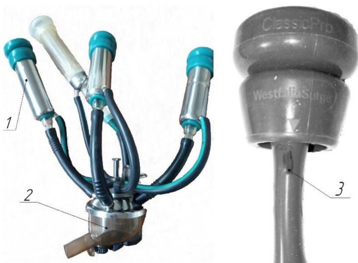
Рисунок 3. Доильный аппарат с изменяемым вакуумметрическим давлением во время такта «сжатие»: 1 – доильный стакан с изменяемым вакуумметрическим давлением; 2 – коллектор; 3 – шлюзовый канал, выполненный в стенке сосковой резины
