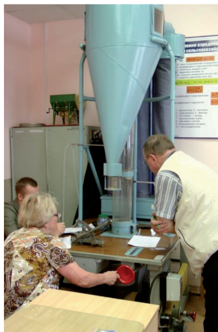
Рисунок 5. – Определение коэффициента парусности и скорости витания
