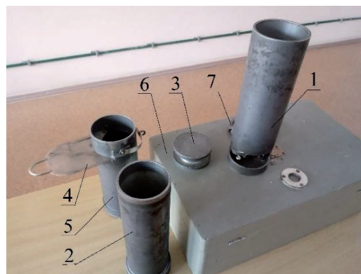
1 – насыпной цилиндр; 2 – наполнитель; 3 – падающий груз; 4 – нож; 5 – мерник; 6 – футляр; 7 – опора
