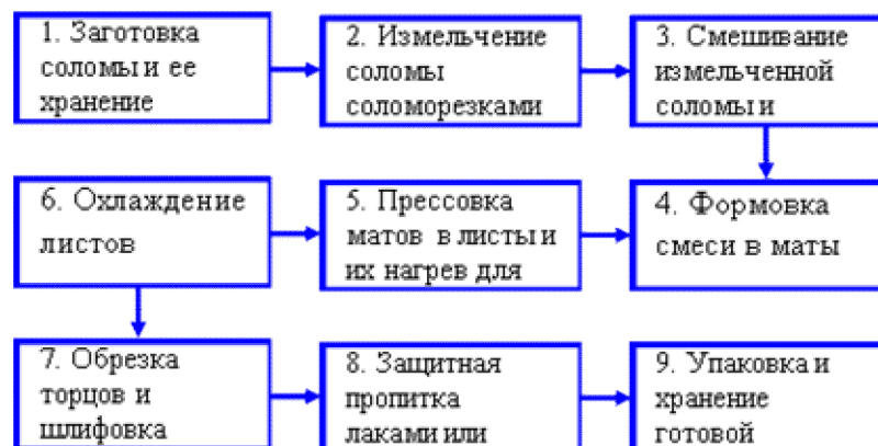
Рисунок 1. Технологическая схема производства OSB плиты из соломы
