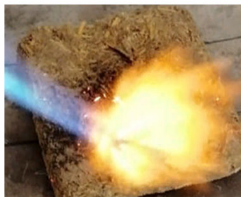
Рисунок 4. Испытание на горючесть экспериментального образца материала
