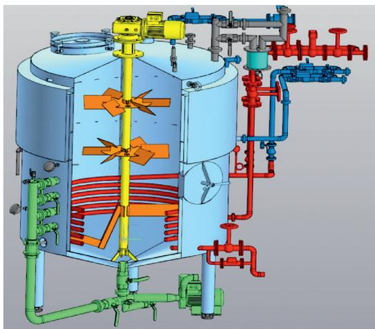
Рис. 8. Аппарат для ферментативного гидролиза и сбраживания
