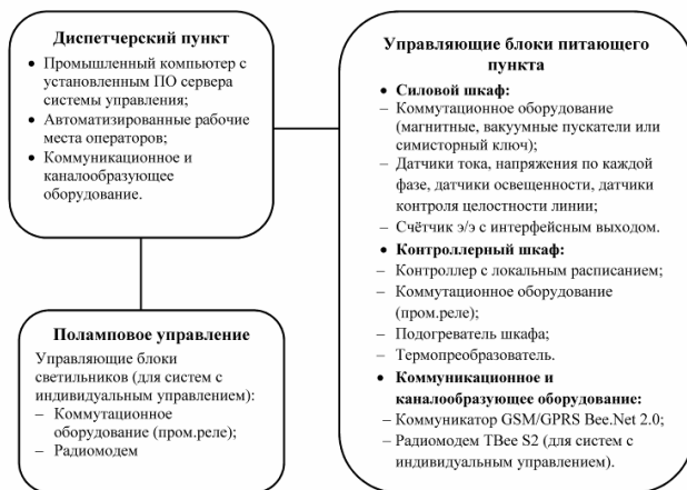
Рисунок 1 – Состав автоматизированной системы управления наружным освещением (АСУНО)
