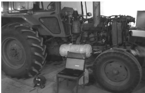
Рисунок 4 – Установка теплового аккумулятора на трактор МТЗ
