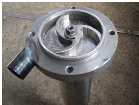
Рис. 2. Насос для перекачки высокотемпературных масел
