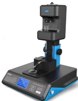
Рисунок 5 – Аналитический феррограф YJF-3 Oil
