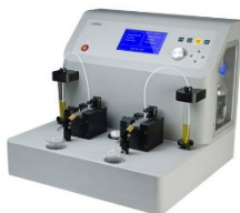
Рисунок 6 – Двойной аналитический феррограф масла YTF-8
