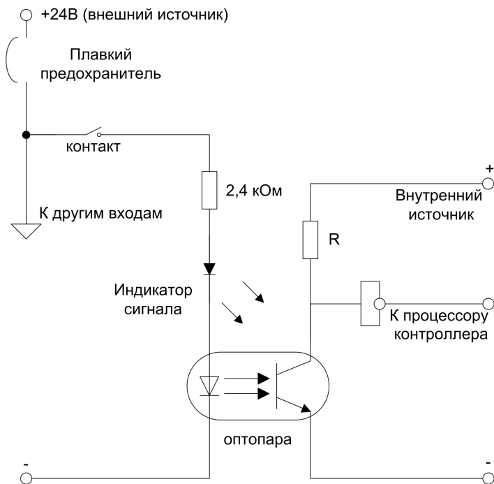
Рис. 9. Принцип работы дискретных входов
