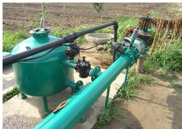
Рисунки 4. Конструкция песчано-гравийных фильтров
