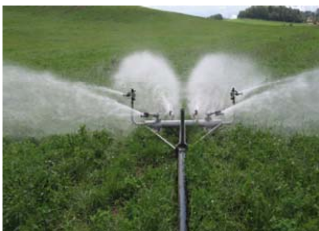
Рисунок 2. Оборудование поливочное ОП-600 в работе
