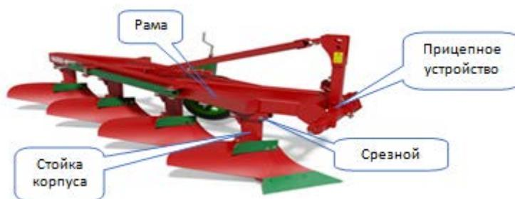
Рис. 1. Плуг AgroMASZ со срезными болтами
