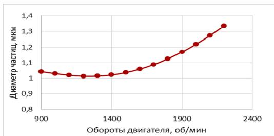
Рисунок 2 – Зависимость размера частиц, совершивших инерционное осаждение в повороте выхлопной системы от оборотов двигателя
