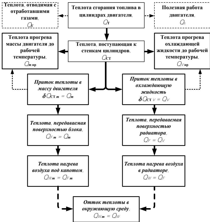
Рисунок 3.9 – Блок-схема оттока теплоты, выделяющейся при сгорании топлива, от двигателя
