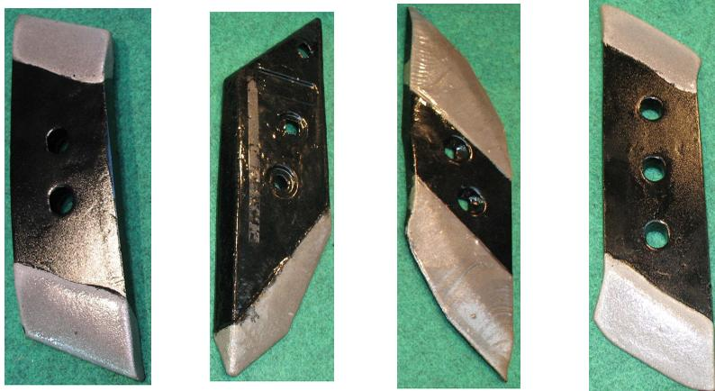
Рисунок 2 – Внешний вид оборотных долот с наплавленными почворезущими профилями
