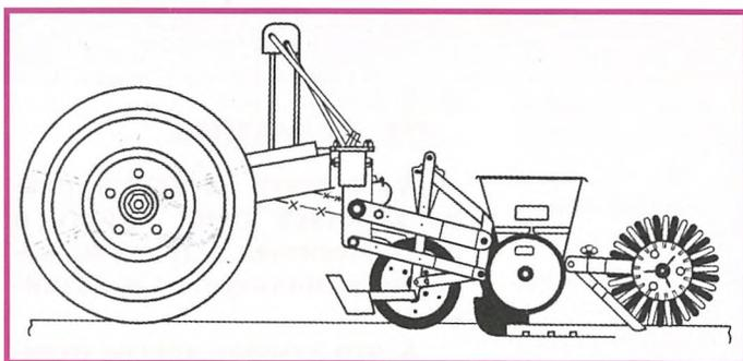
Сеялка механическая навесная **СМН-12** предназначена для точного высева дражированных семян сахарной и кормовой свеклы на минеральных и торфяных почвах.
