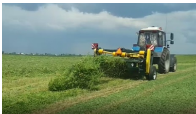
Рисунок 2. Устройство УПВТ-4,0 при выполнении технологического процесса площения бобовых трав
