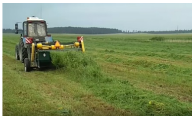
Рисунок 3. Устройство УПВТ-4,0 при выполнении технологического процесса вспушивания злаковых трав
