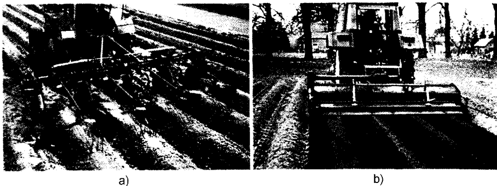
Fot. 3.16. Obsypniki ziemniaczane czterorzędowe podczas pracy: a) z biernymi elementami roboczymi, b) z aktywnymi spulchniaczami i blachami formującymi redliny Photo 3.16. Four-row potato ridgers: a) with idle working elements, b) with rotary cultivator and ridge shaping sheet metal forms
