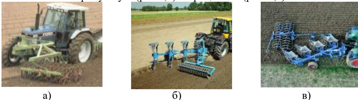
Рис. 2. Схемы установки катковых приставок на пахотных агрегатах: а – навешиваемые спереди трактора; б – навешиваемые на раму плуга; в – прицепные
