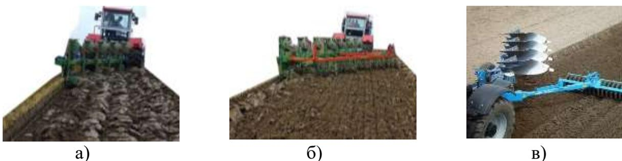
Рис. 3. Особенности обработки тяжелых и легких почв: а – тяжелые почвы после вспашки; тяжелые (б) и легкие (в) почвы после вспашки с одновременной обработкой поверхности почвенного пласта катковыми приставками
