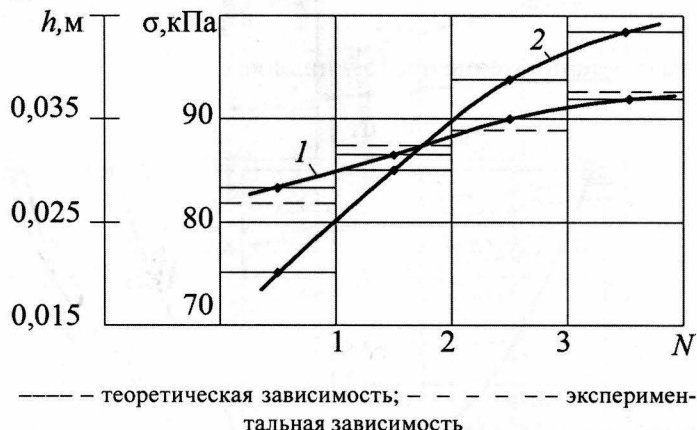
Рис. 5. Нарастание глубины следа (кривая 1) и контактных напряжений (кривая 2) для сильно упрочняющейся почвы под воздействием многоосной ходовой системы
