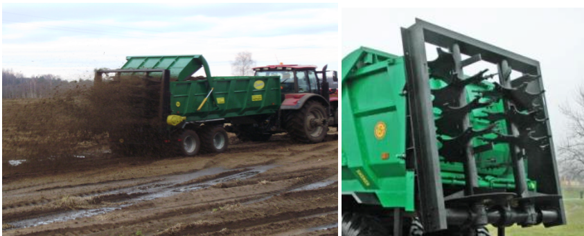
Рисунок 1 – Универсальное транспортное средство УПТС-15 (а) и разбрасывающее устройство (б)
