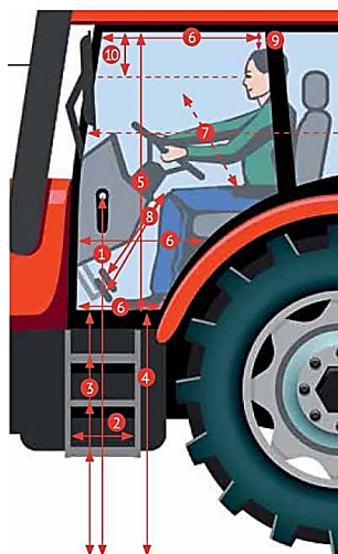
Рисунок 1. Схема измерений эргономических параметров кабины и средств доступа в нее
