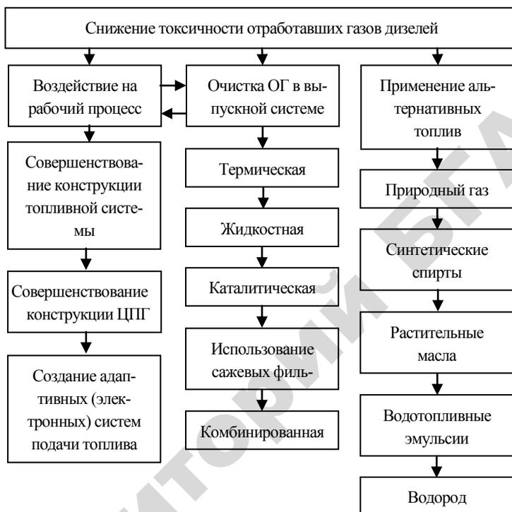
Рис. Способы снижения токсичности ОГ дизелей
