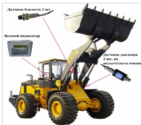
Рис. 33. Установка весовой системы Pegasus 2 (Италия) на одноковшовом фронтальном на погрузчике
