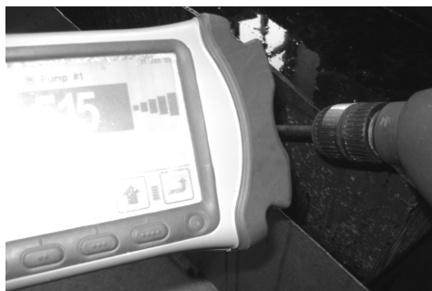
Рис. 9.4. Дисплей бесконтактного тахометра DeLaval VPR100 во время измерения частоты вращения лопастной мешалки
