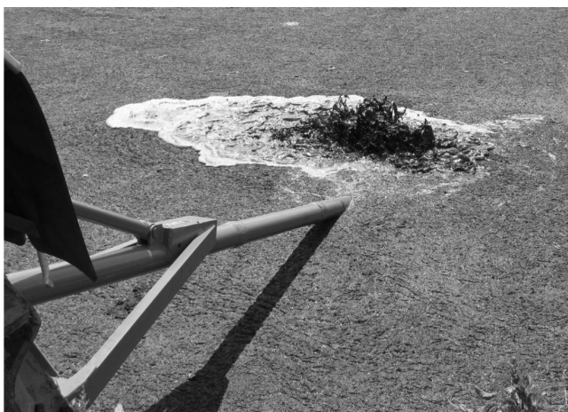
Рис. 9.10. Гомогенизатор в процессе перемешивания жидкого навоза
