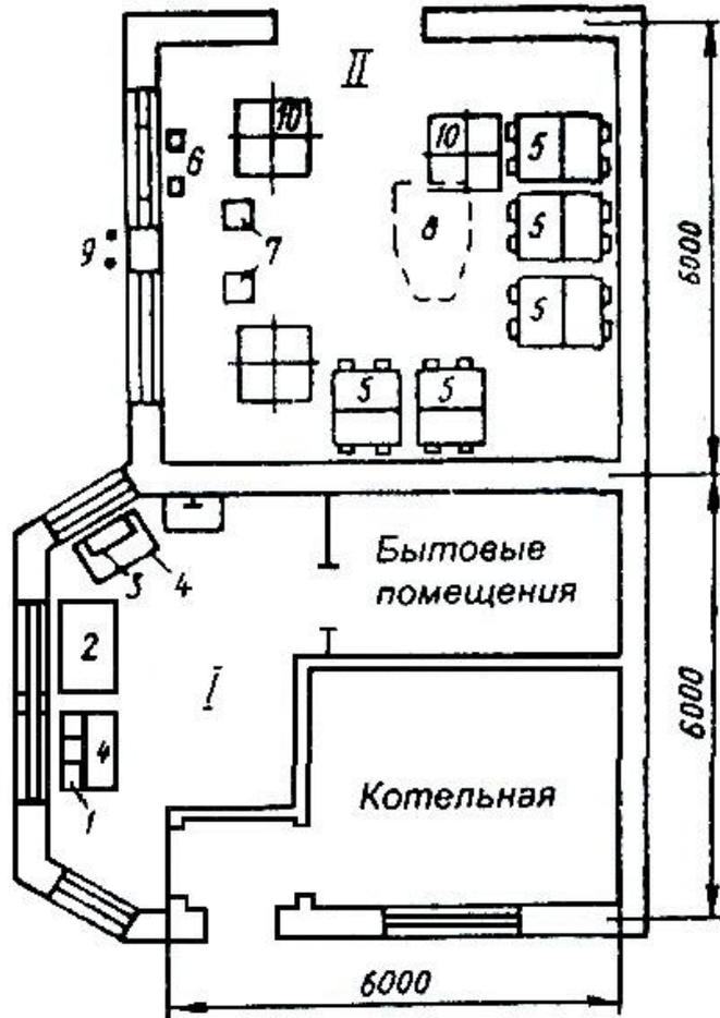
Рисунок 3.1 – План операторской с маслоскладом и маслораздаточной (нефтесклады вместимостью 40, 80 и 150 м<sup>3</sup>):
