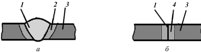
Рис. 11.3. Сварные соединения, выполненные сваркой плавлением (а) и сваркой давлением (б): 1 – сварной шов; 2 – зона термического влияния; 3 – зона основного металла; 4 – зона механического влияния
