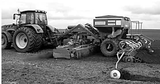
*Рис. 4.5. Агрегат почвообрабатывающе-посевной АППА-6*
