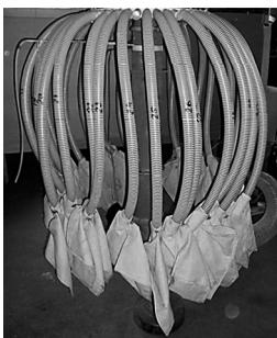
Рис. 3.3. Общий вид экспериментального распределителя вертикального типа
