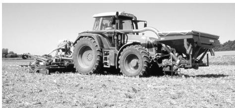
Рис. 1.8. Сеялка DF-1 фирмы «Accord» (Германия)
