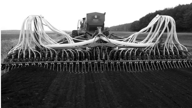
*Рис. 3.6. Сеялка С-9, подготовленная к натурным испытаниям*
