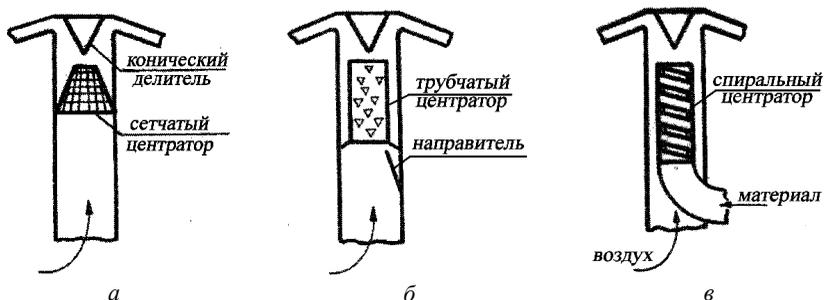
Рис. 1.30. Типы центраторов посевного материала
