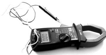
Рис. 3.14. Прибор K4570/2Ц для измерения силы тока и напряжения в сети
