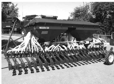
*Рис. 1.4. Сеялки пневматические СПУ-6*
