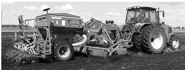
Рис. 4.6. Агрегат почвообрабатывающе-посевной АППА-4
