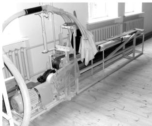
Рис. 3.11. Экспериментальная установка для определения продольной неравномерности (общий вид)
