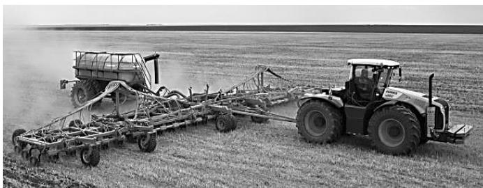
*Рис. 1.13. Сеялка с пневматической системой высева*
