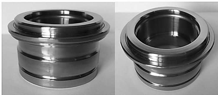
*Рис. 5.12.* Фотография образца после MAO до начала эксперимента
