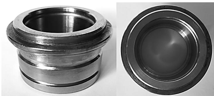
*Рис. 5.13.* Фотография образца после MAO через 240 часов
